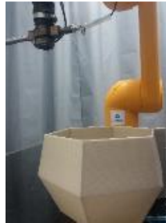
Figure 5 : Vase imprimé à partir de granulés par bras robotisé 6 axes (développement CANOE)
