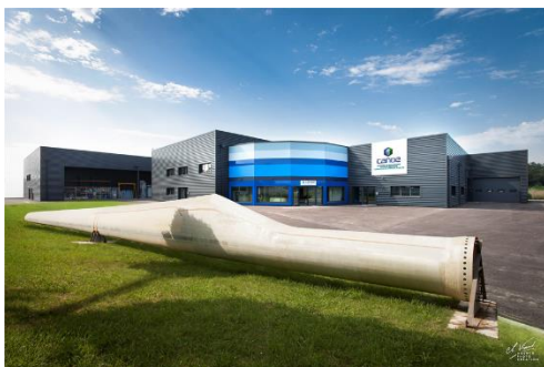
Figure 1 : Pale éolienne Fibres de verre infusée Elium® et broyats
