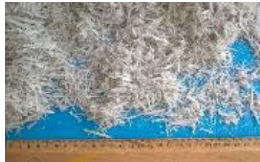
Figure 1 : Pale éolienne Fibres de verre infusée Elium® et broyats
