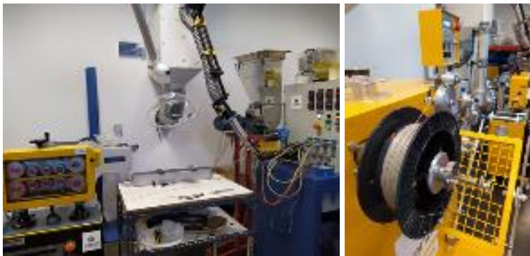
Figure 3 : Ligne de Filage – Bobinage – Développement CANOE
