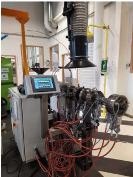
Figure 6 : Extrudeuse monovis CANOE avec pompe CO 2 supercritique
